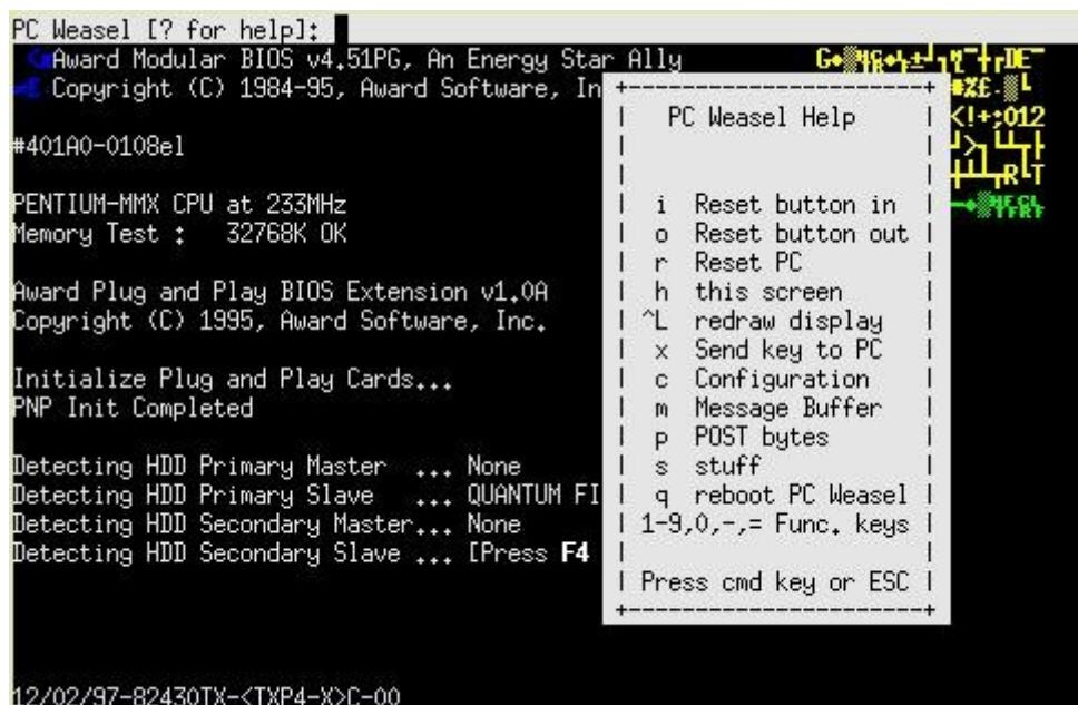
**Рисунок 6 инженерное меню, высвечиваемое PC Weasel 2000**
