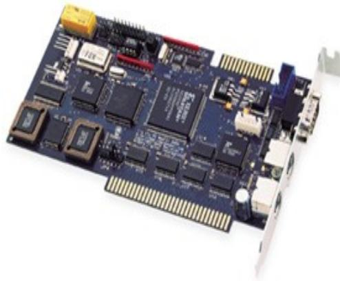
**Рисунок 5 еще одна плата удаленного управления, на этот раз – PC Weasel 2000**
