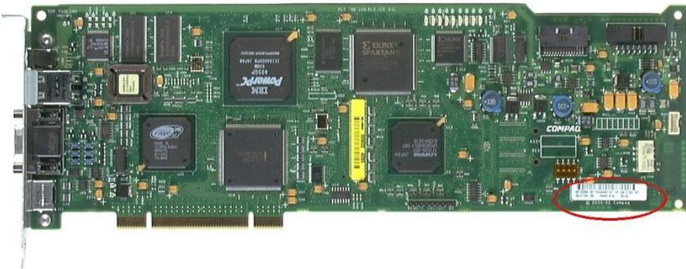
**Рисунок 12 SCSI-контроллер со съемным BIOS'ом, который легким движением руки превращается в плату удаленного управления**
