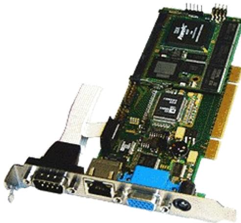
**Рисунок 7 плата удаленного управления типа eRIC enhanced Remote Management Card**
