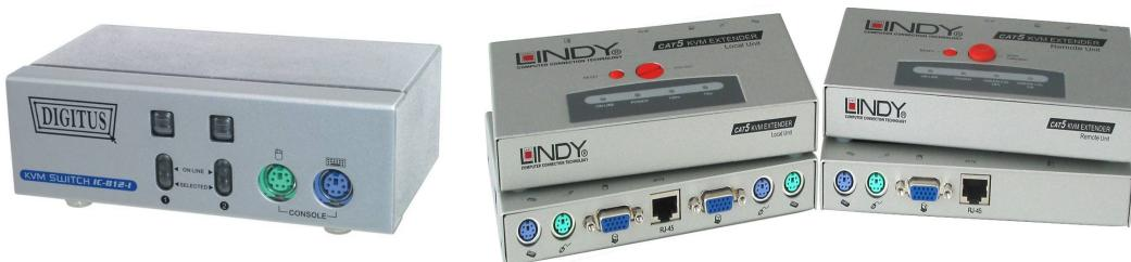
**Рисунок 10 внешний вид некоторых KVM-коммутаторов**
