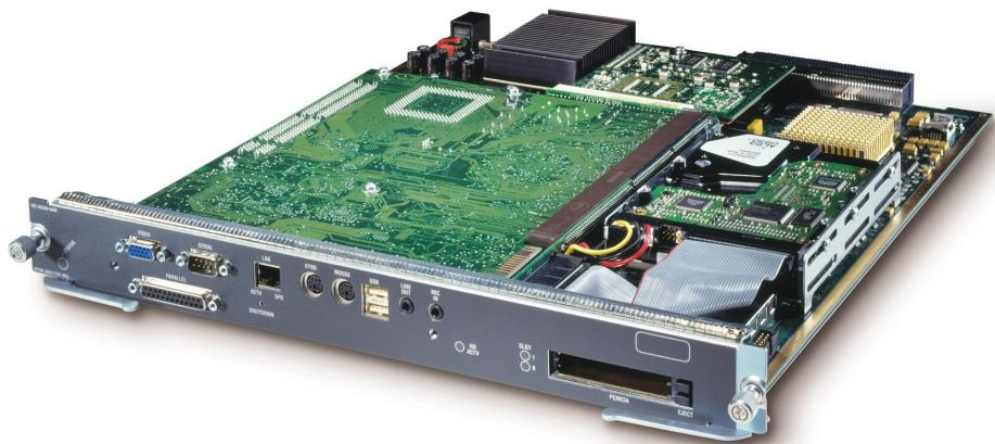
**Рисунок 2 аппаратный IDS модуль для маршрутизатора CISCO Catalyst 6000 Series**
