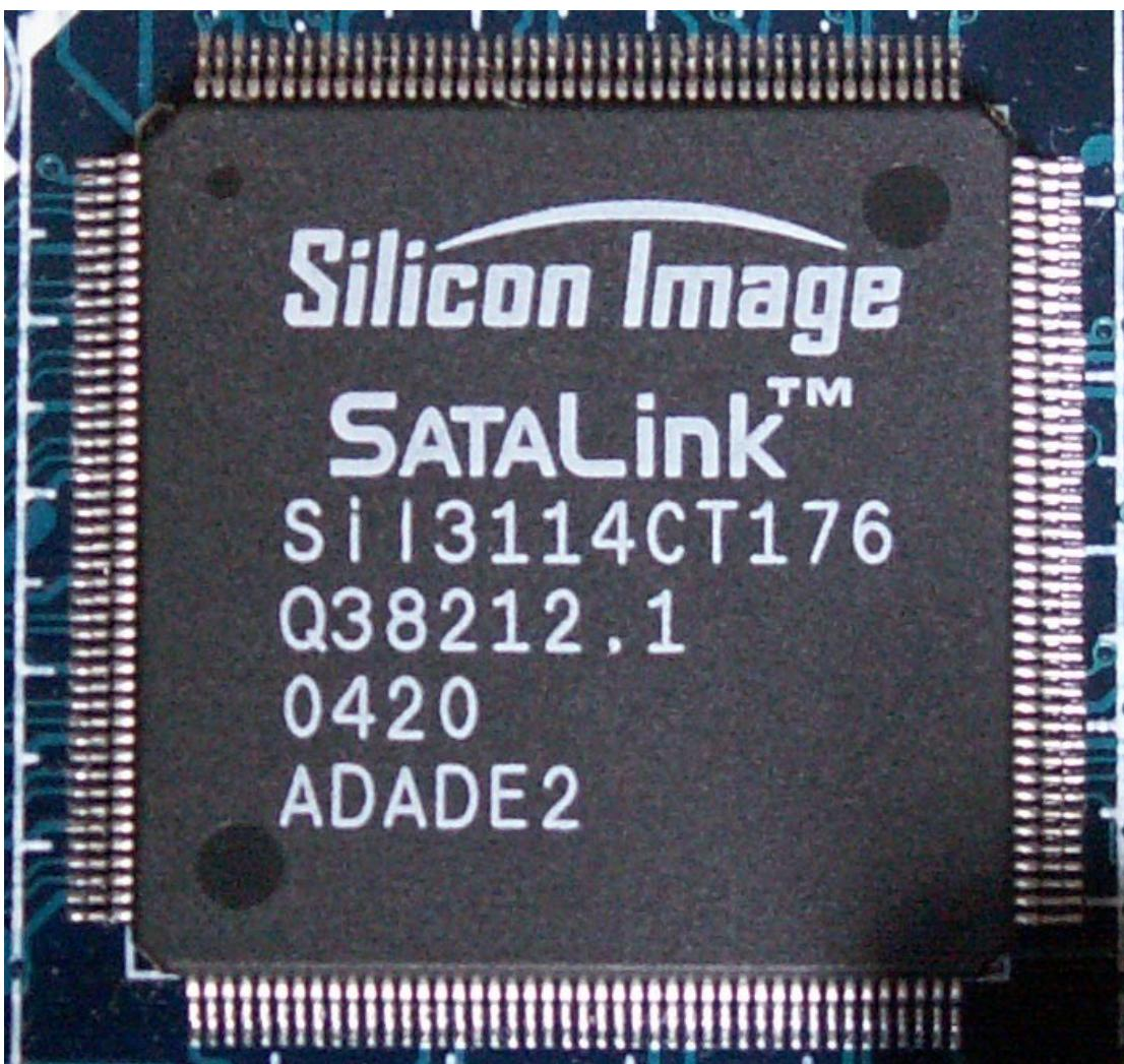
**Рисунок 6 чип от Silicon Image – сердце RAID-контроллера**
