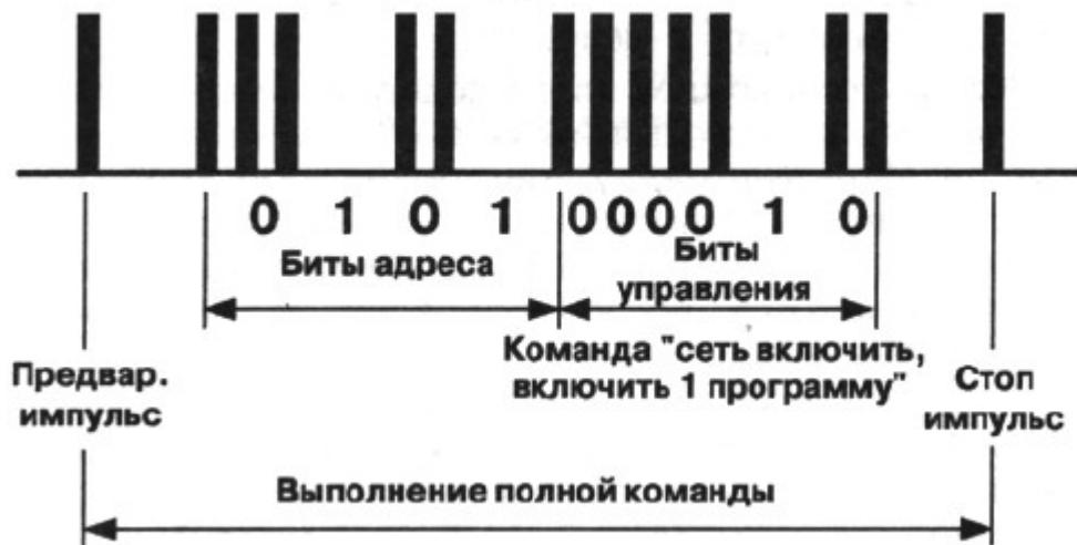
Рисунок 13 принцип кодирования информации в системе ИТ
