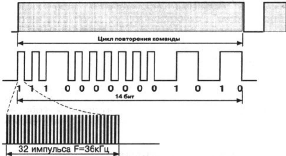
Рисунок 14 принцип кодирования информации в системе RC-5
