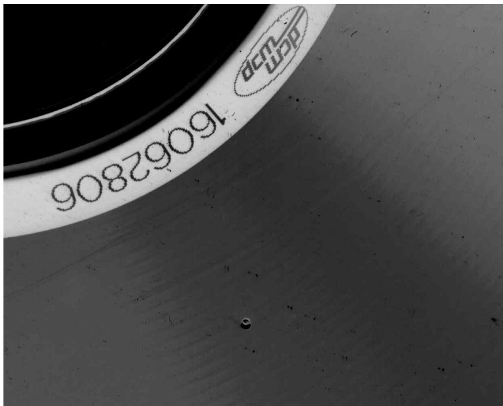
Рисунок 3 лазерный диск, защищенный Laser Lock ("снимок" получен сканером HP 1200)
