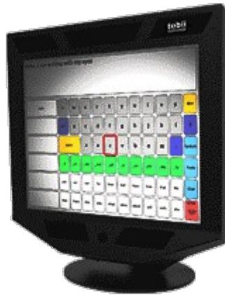
**Рисунок 8 виртуальная клавиатура бесконтактного интерфейса "My Тобii" от компании "Eye Control System", управляемая взглядом и ориентированная на людей с ограниченными возможностями**
