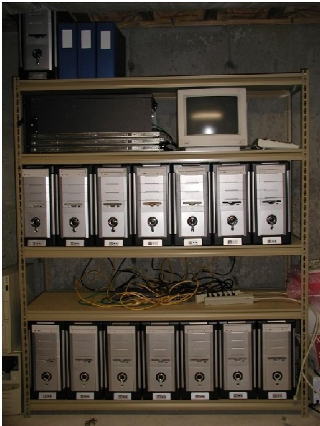
Рисунок 7 НРС-кластер, собранный на базе обычновенных ПК
