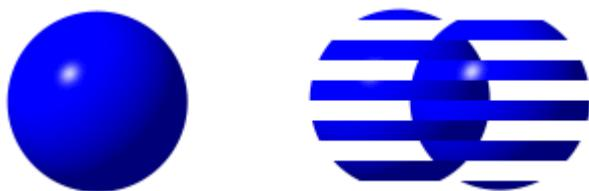
**Рисунок 3 так выглядит неподвижный (слева) и движущийся (справа) мяч, снятый в ч/с режиме и выводимый на прогрессивный монитор**
