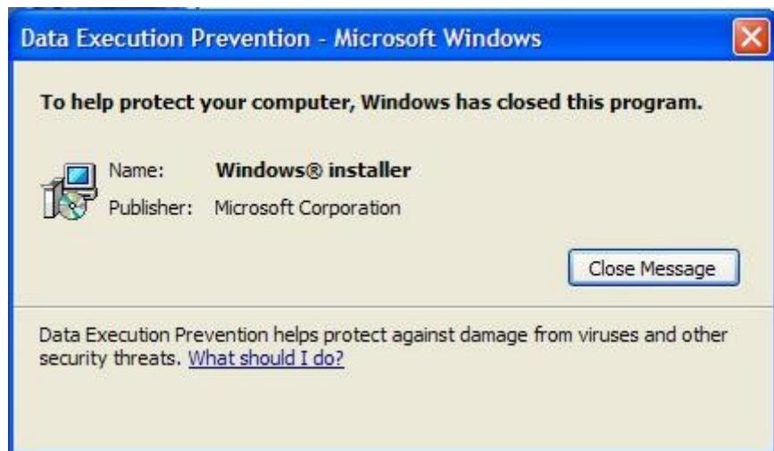
**Рисунок 5** реакция DEP на попытку выполнения кода на стеке
