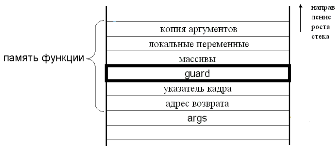
Рисунок 5 безопасная модель стека Pro-Police
