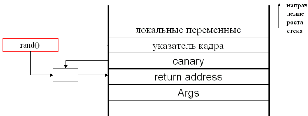
Рисунок 2 адрес возврата поXOR'ый случайным canary
