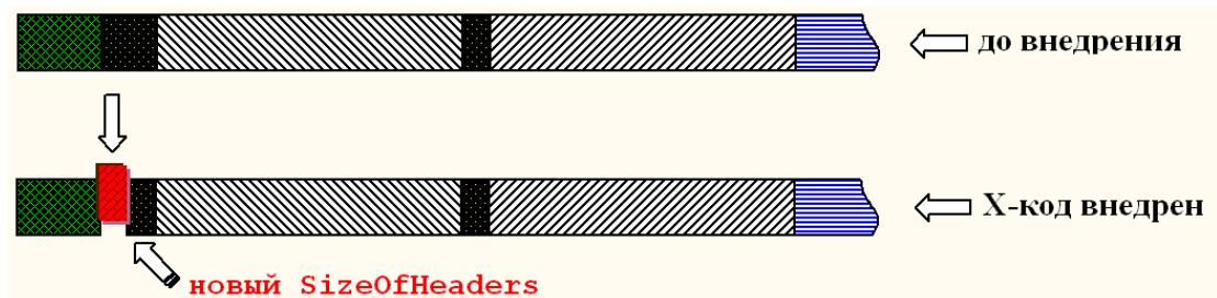
Рисунок 2 внедрение X-кода в свободное пространство хвоста PE-заголовка
