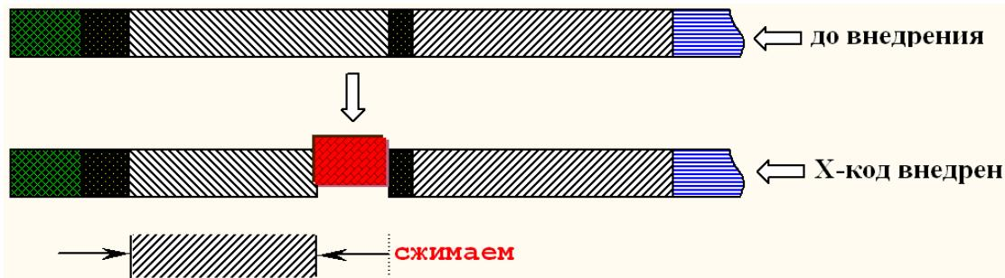
Рисунок 9 внедрение X-кода путем сжатия секции
