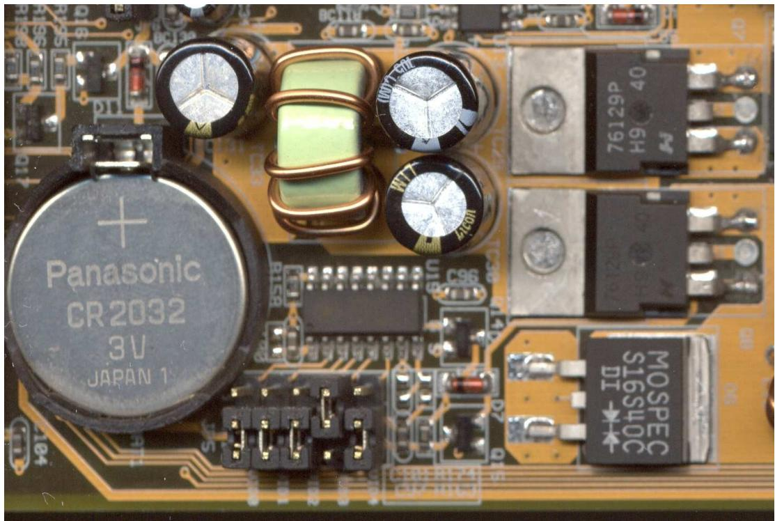
**Рисунок 15 типовой стабилизатор, управляемый juper'ами**
